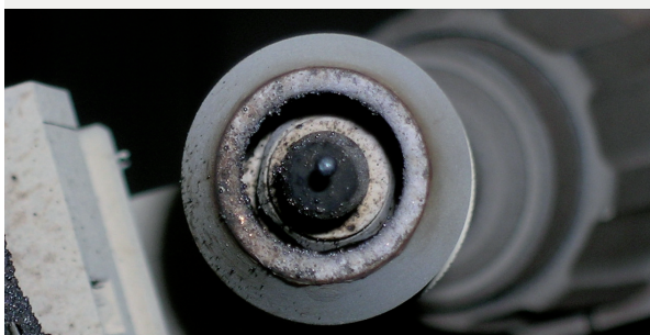
A különbség bevonat alkalmazásával és anélkül 75 perc hegesztés után.
